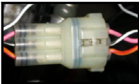
Der Tachogeber sitzt links auf der Achse des Vorderrades. Von ihm gehen 3 Kabel ab, ein orange-rotes (+), ein schwarz-weißes (-) und ein pinkes (Tachosignal). So, nun wäre es natürlich viel zu einfach, wenn man das pinke Kabel mit dem weißen des Motoscopes verbindet. Denn die nötige 12V Spannung im orange-roten Kabel liegt nur dann an, wenn der Original Tacho dran hängt.
